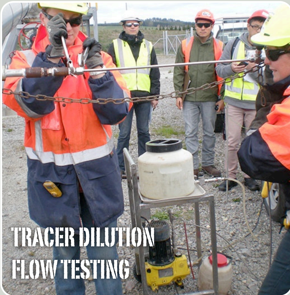
Demonstrasi tracer dilution flow testing yang dilakukan oleh para engineers di lapangan Rotokawa
